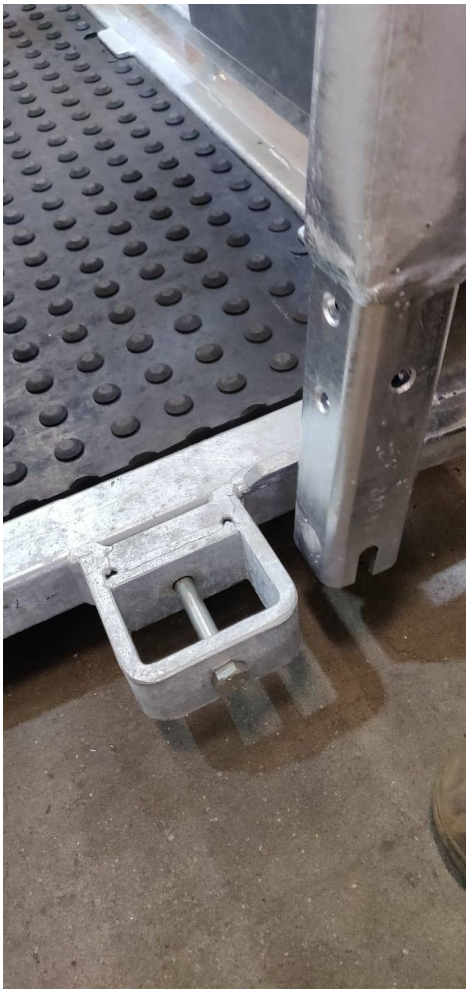
Abbildung 7: Vorderes Tor lösen
